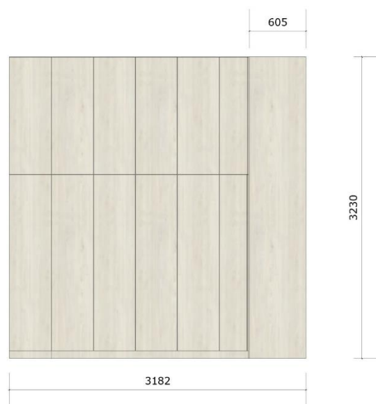
STÁVAJÍCÍ OBLOŽENÍ ZDÍ A DVÍŘKA VESTAVĚNÉ SKŘÍŇĚ - VÝMĚNA DEKOR WHITE NORDIC WOOD ( KRONOSPAN ) - ÚPRAVA RASTRU DLE MOŽNOSTÍ
